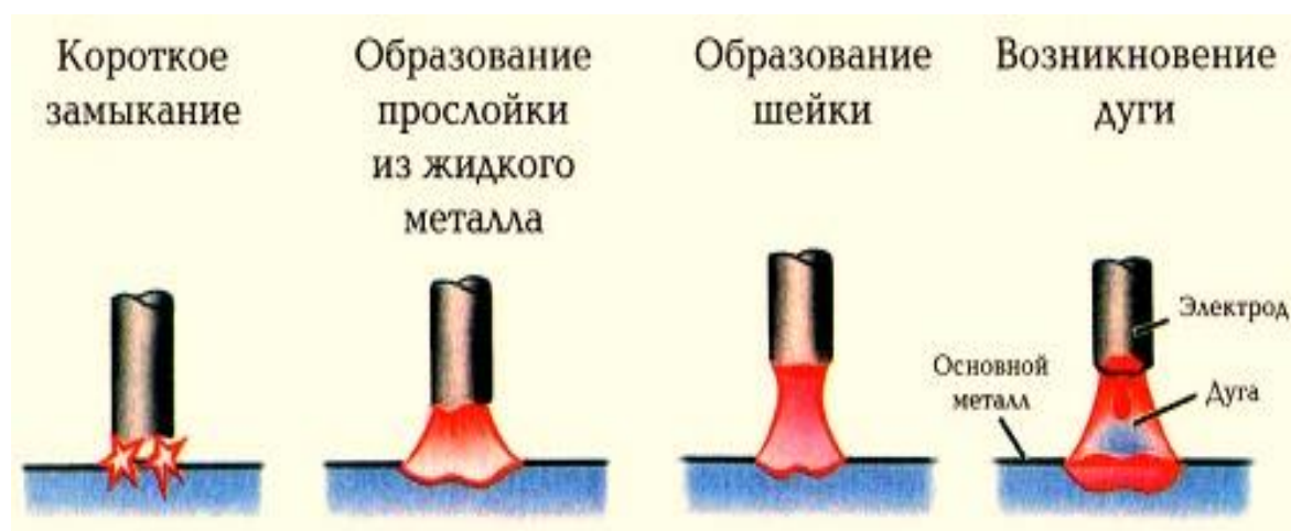
Рис. 5.3. Схема процесса зажигания дуги
