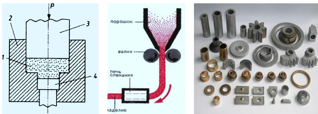
Рис. 4.56. Схемы формовки изделий из порошковых материалов и готовая продукция:
