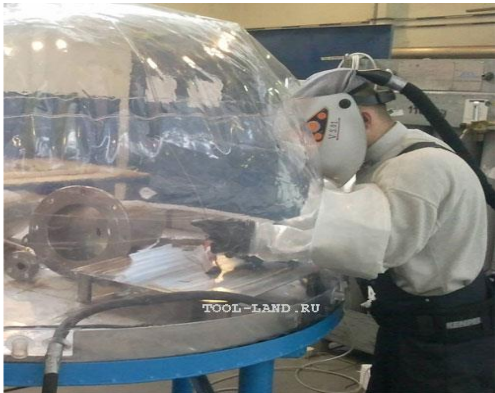
Рис.5.59 Сварка титана в специальной камере
