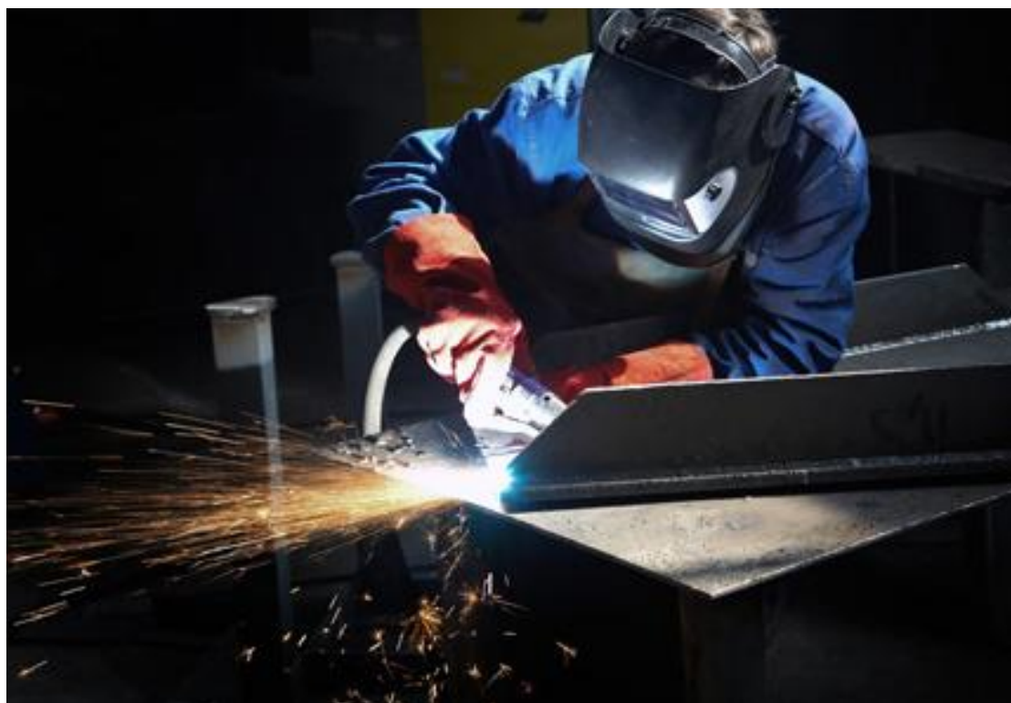
Рис.5.17. Сварка в защитном газе
