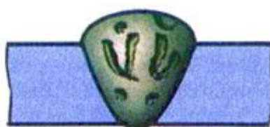
Рис.5.61 Продольная трещина сварного соединения
