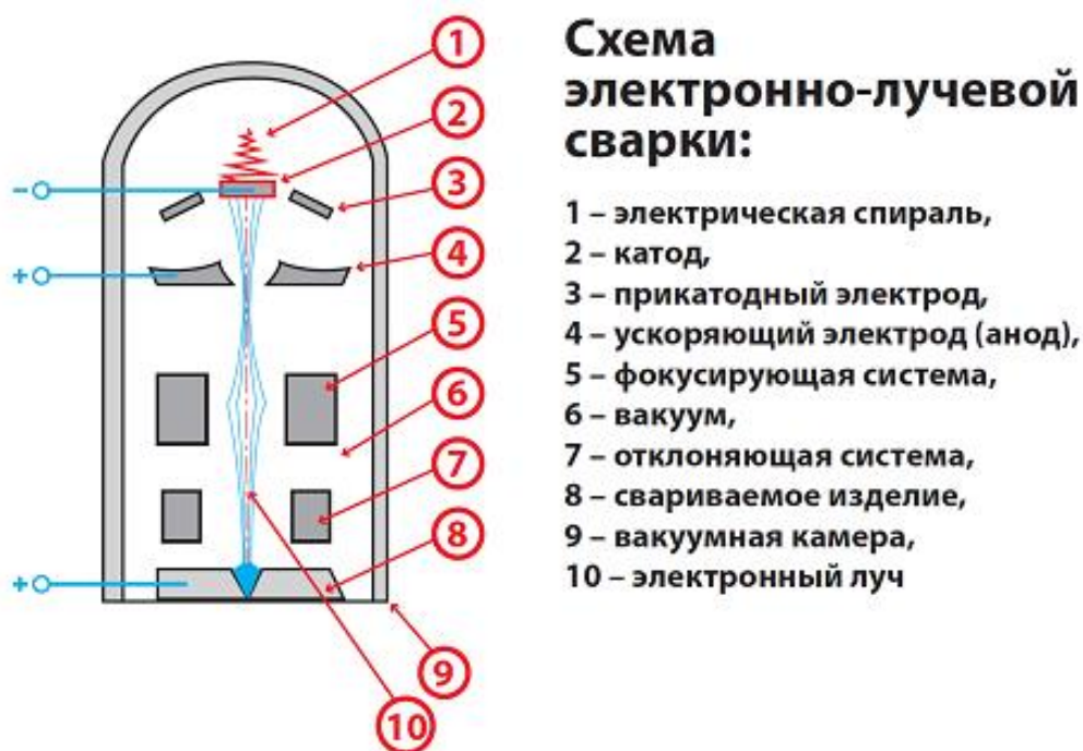
Рис.5.32. Схема установки электронно-лучевой сварки
