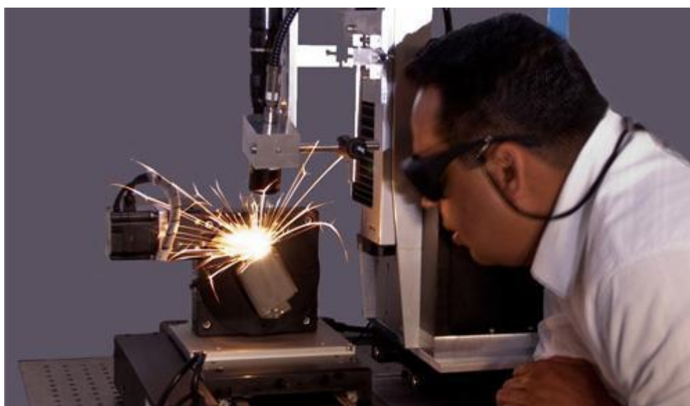
Рис.5.36. Установка для лазерной сварки
