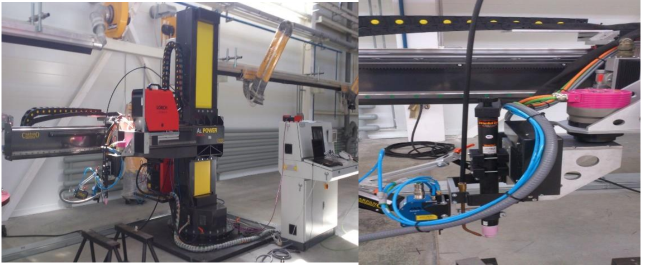
Рис.5.56 Установка для автоматической аргодуговой сварки продольных и кольцевых швов обечаек из алюминиевых сплавов
