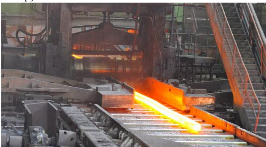
Рис.4.10. Прокатный стан (блюминг) дающий заготовку для сортового проката
