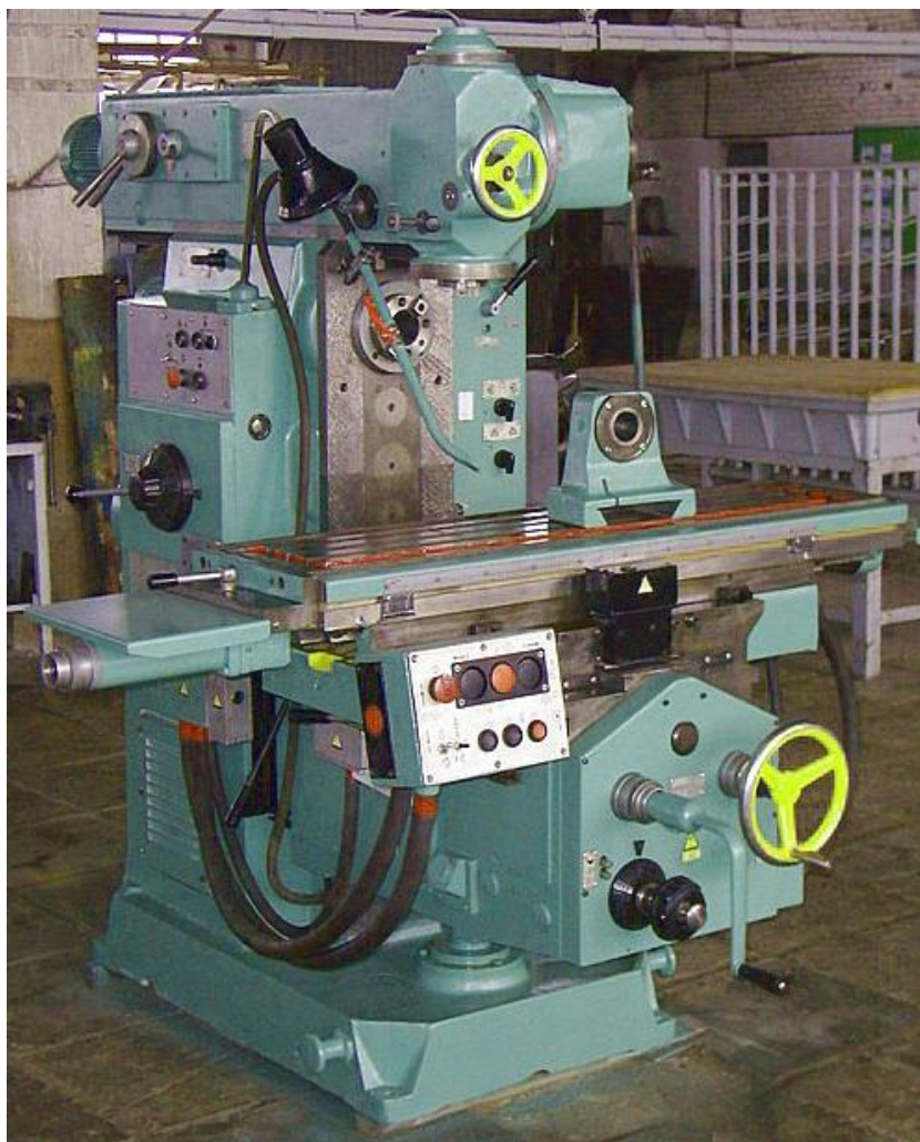
Рис.6.27. Широкоуниверсальный фрезерный станок модель 6Д82Ш
