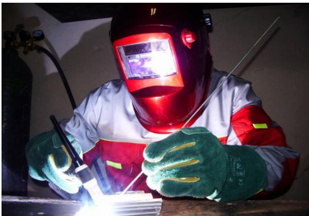
Рис.5.51 Холодная сварка чугуна медно-железным электродом
