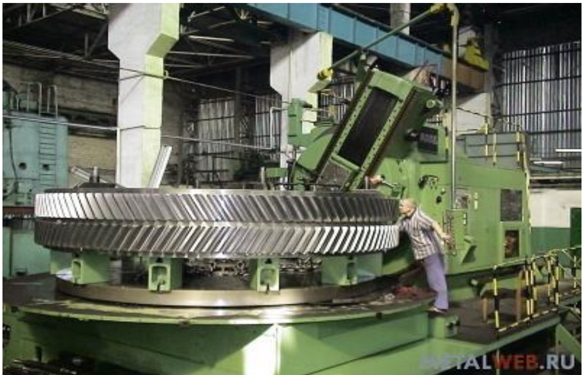
Рис.6.93. Нарезание конических зубчатых колёс круговой резцовой головкой
