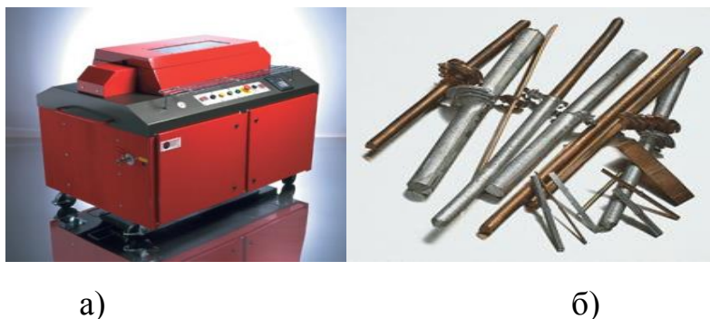
Рис. 5.40. Электropневматический аппарат для сварки прутьев, проволоки и полосы цветных металлов диаметром от 5 до 12,5 мм (а) и длина сваренных медных и алюминиевых прутьев (б)
