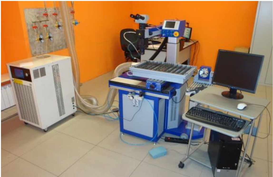
Рис.5.37. Импульсная лазерная установка для сварки, резки и термообработки
