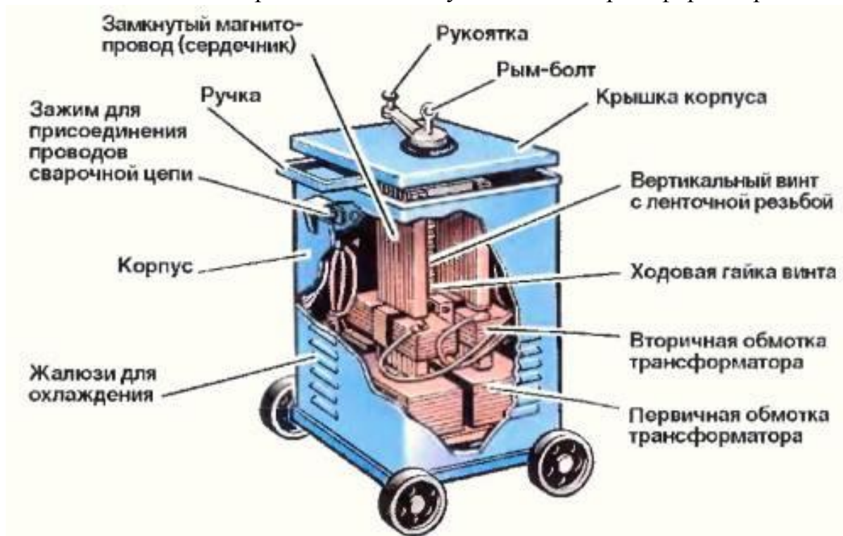
Рис.5.6. Устройство трансформатора ТСК – 500
