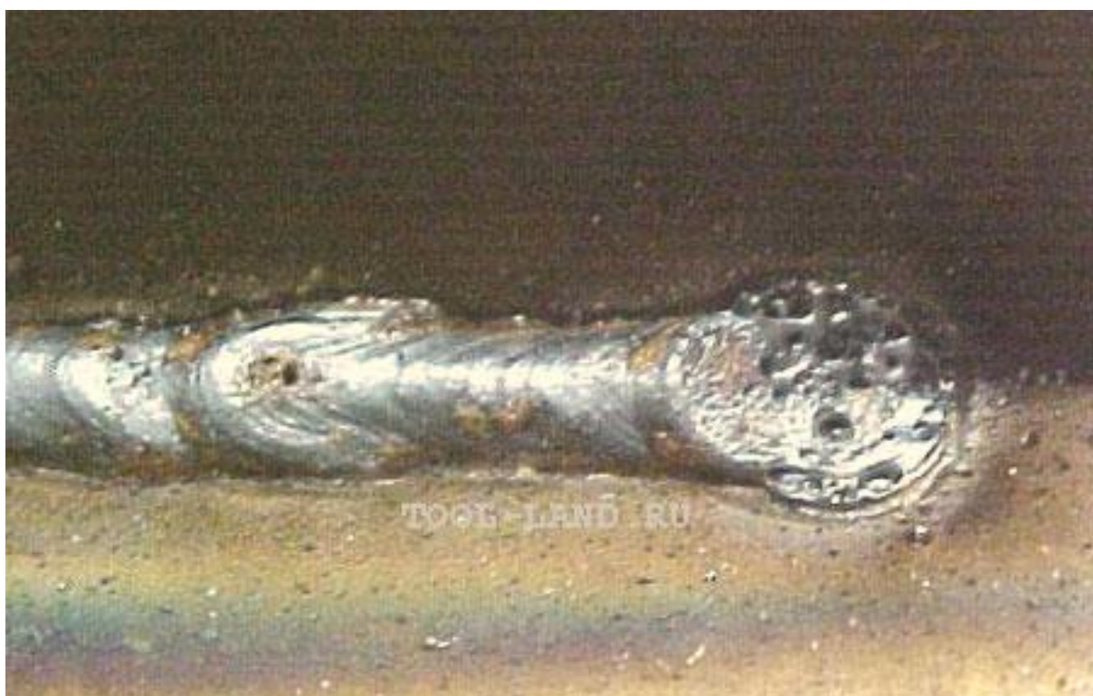
Рис.5.62 Пористость в сварном шве
