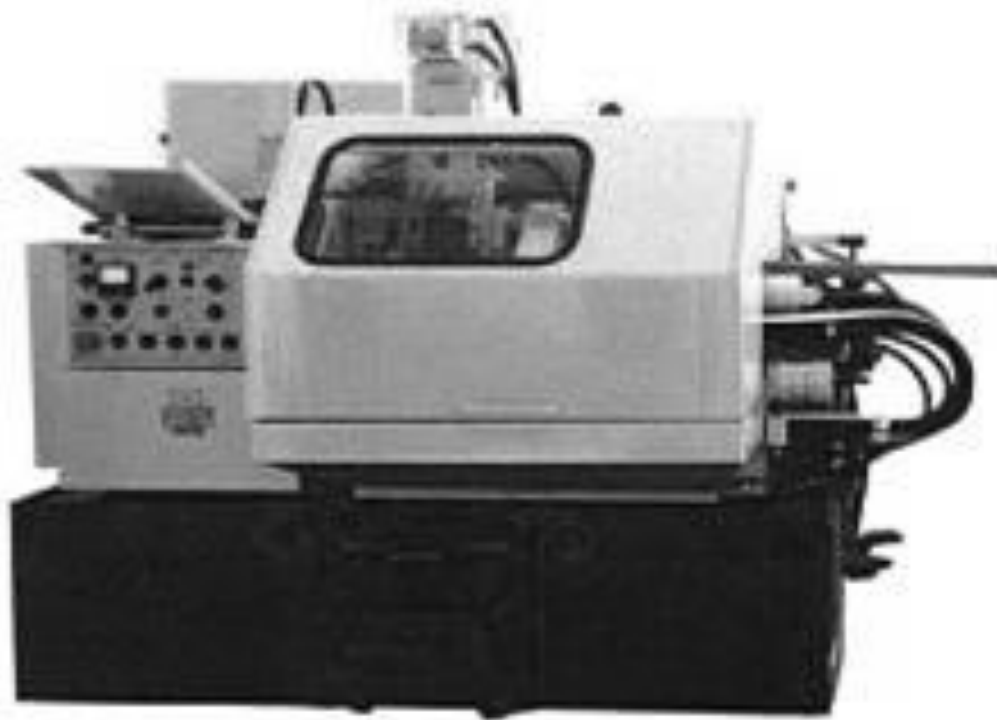
Рис.6.51, в – токарный гидрокопировальный автомат КТ131
