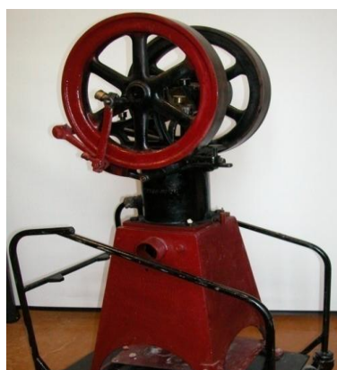
Рис. 3.5.7. Двигатель внешнего сгорания (двигатель Стирлинга)
