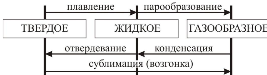
Рис. 3.6.1. Схема возможных изменений агрегатного состояния вещества
