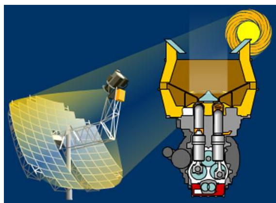
Рис. 3.5.8. Двигатель Стирлинга, работающий от солнечной энергии
