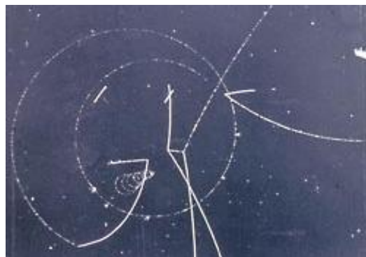
Рис.1.10.12. Треки частиц при аннигиляции антипротона на протоне
